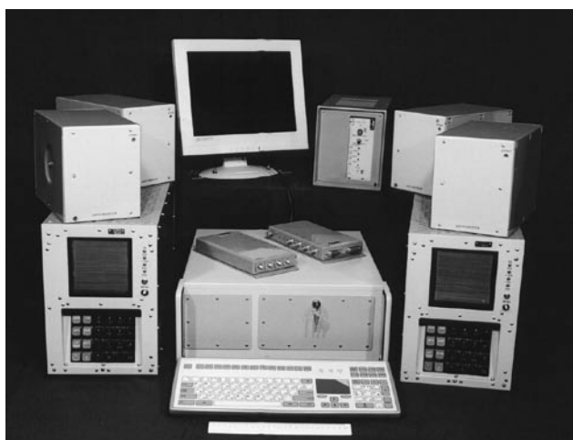
Рис.1. Комплекс аппаратуры управления и синхронизации передающих станций ИФРНС «Чайка»
