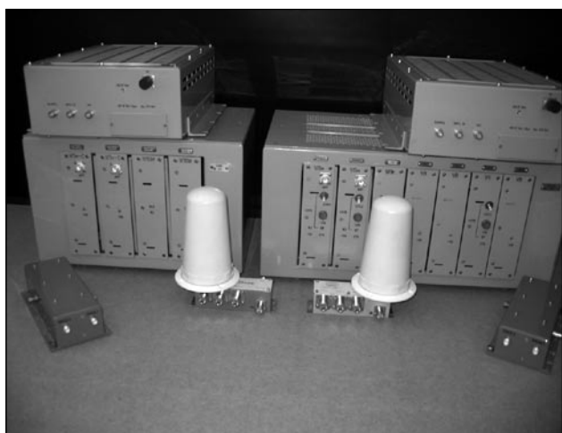
Рис.2. Экспериментальный образец региональной контрольно-корректирующей станции СРНС ГЛОНАСС/GPS
